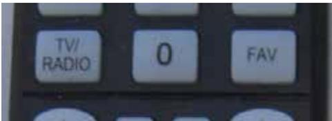
Befindet sich das Gerät im IP Mode, kann mit der „TV/Radio“ Taste in den TV Mode gewechselt werden. Es werden nur die Signalwege umgeschaltet, die Satellitenposition wird nicht verändert.
