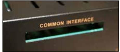
An der Frontseite des Gerätes finden sich ein Einschub, der zur Aufnahme von Modulen zur Dekodierung verschlüsselter Programme vorgesehen ist. Um eine Beschädigung zu vermeiden, dürfen ausschließlich Module gesteckt werden, die das „PC Card“-Logo tragen. Andere Module können irreparable Schäden am Receiver verursachen.
