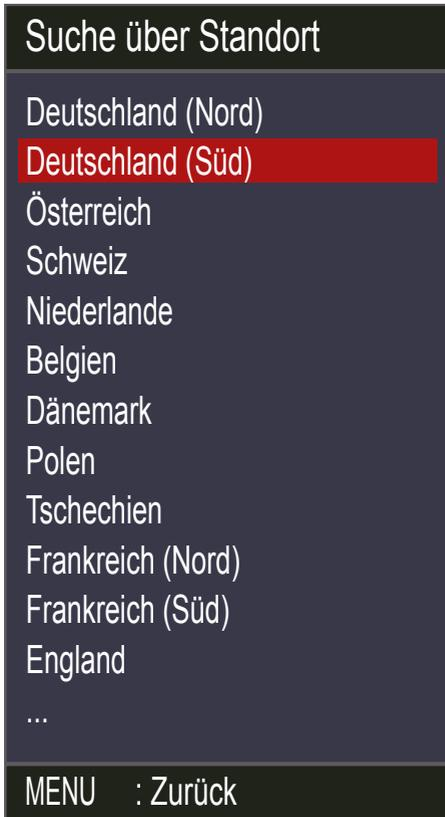
Bei Anwahl dieses Menüpunktes „**Suche über Standort**“ öffnet sich ein Untermenü zur Auswahl von verschiedenen Ländern bzw. Gegenden. Mit den Cursor Tasten (Menunavigations-tasten hoch/runter) kann ein Eintrag angewählt und dann mit OK aktiviert werden.
