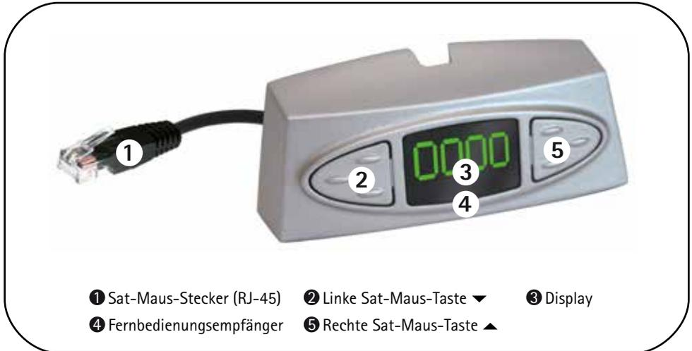
Über die zwei Tasten an der abgesetzten Anzeigeeinheit (Sat-Maus) ist eine Notbedienung des Receivers möglich, wenn keine Fernbedienung vorhanden ist. Dabei haben die Tasten folgende Funktionen:
