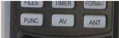
Mit der „AV“ Taste kann zwischen IP Mode und TV Mode umgeschaltet werden. Es werden nur die Signalwege umgeschaltet, die Satellitenposition wird nicht verändert.
