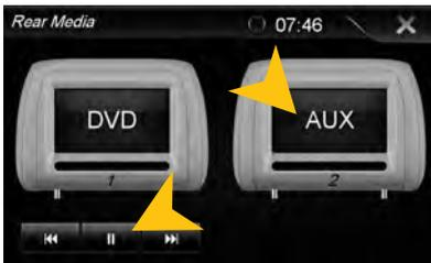
Sollten im Fondbereich z.B. zwei Kopfstützenmonitore installiert und korrekt ans Gerät angeschlossen sein, können Sie dort mit der Real Dual Zone-Funktion unabhängig vom Hauptmonitor DVD, TV oder AUX wiedergeben.
