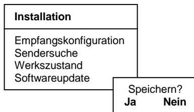
Wählen Sie mit den Tasten ◀▶ **Ja** um den Werkzustand wieder herzustellen oder **Nein** um das Menü zu verlassen und bestätigen Sie dies mit der Taste **OK**.
