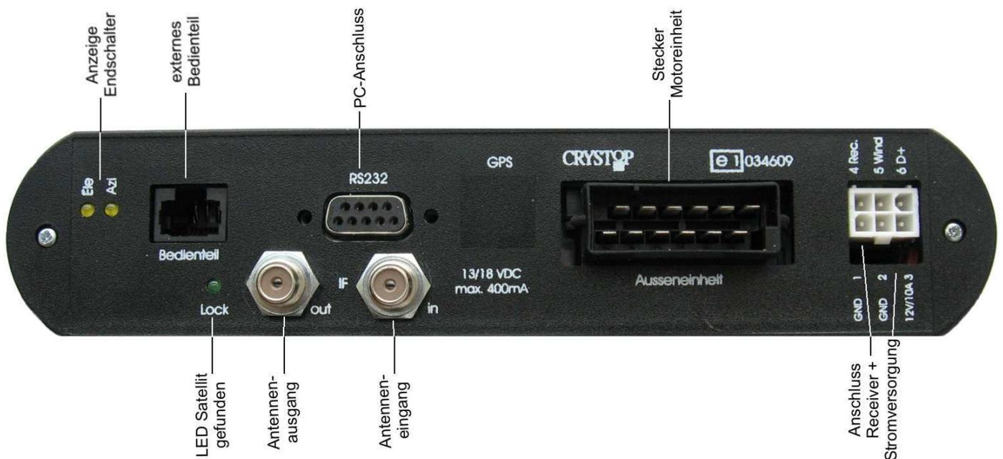
Verlegen Sie die Kabel der Außeneinheit im Fahrzeuginnern zur EasySat<sup>®</sup>. Die Kabel dürfen nicht an scharfen Kanten reiben oder in der Nähe von Wärmequellen verlegt werden.
