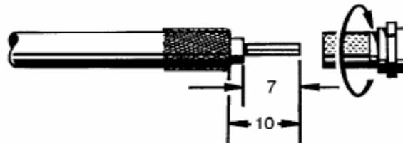
Das Antennenkabel der Außeneinheit wird am linken mit „in“ beschrifteten F-Anschluss aufgeschraubt.
