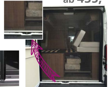
Fliegenschutz für Heckklappe
